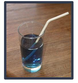
La RIFRAZIONE è quel fenomeno per cui, quando la luce (o in generale un'onda elettromagnetica) attraversa la superficie di separazione fra due sostanze trasparenti (come ad esempio aria e vetro oppure aria ed acqua), il raggio incidente subisce una deviazione rispetto alla sua direzione iniziale.
